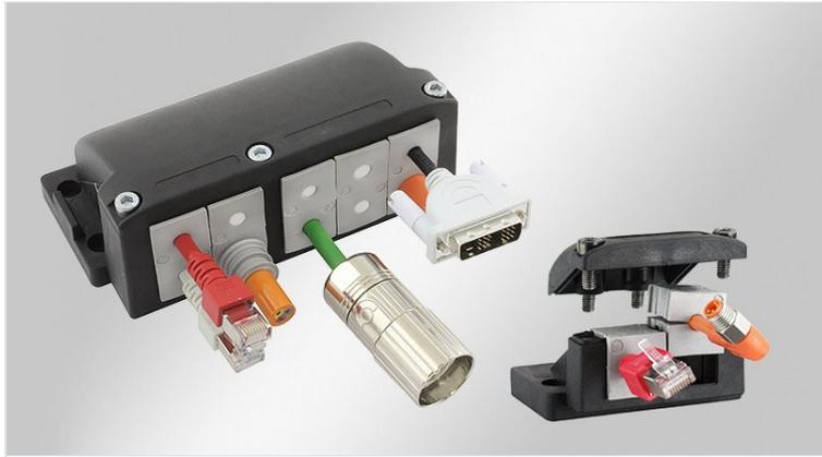
ケーブルエントリーフレームKEL-FGは、キャビネット、壁に対して90°の角度でケーブルを挿入し、シールし、ストレインリリーフすることができます (DIN EN 62444に準拠)。コネクタの有無にかかわらず、ケーブルやホースをスムーズに挿入できます。
