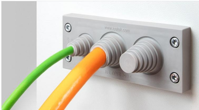
Vous ne connaissez pas exactement le diamètre de tous les câbles au moment de l'installation par ex. sur le chantier? Les plaques passe-câbles KEL-DPFR permettent d'introduire plusieurs câbles de diamètres différents de 3 à 28 mm et de les sceller selon IP66.
