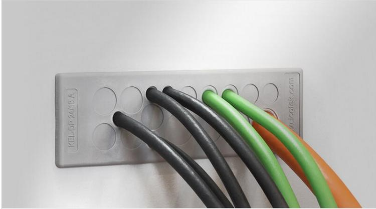
Die Baureihe KEL-DP dient zur Einführung nicht konfektionierter Leitungen. Ein kleiner Stich in die Membran genügt, anschließend können die Leitungen durchgeschoben werden.
