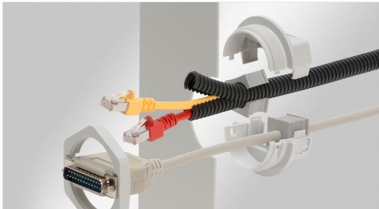
Die teilbare Kabelverschraubung KVT ermöglicht die schnelle Einführung und Abdichtung (IP54) von Leitungen mit Steckern oder fertigen Kabelsätzen. Aber auch nicht konfektionierte elektrische, pneumatische oder hydraulische Leitungen sowie Wellschläuche lassen sich mit der teilbaren Kabelverschraubung KVT problemlos in Schaltschränke, Gehäuse oder Maschinen einführen und abdichten.
